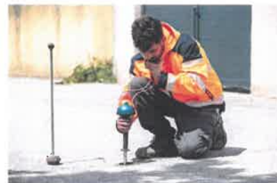
Recherches acoustiques fines de fuites par les agents du service exploitation
